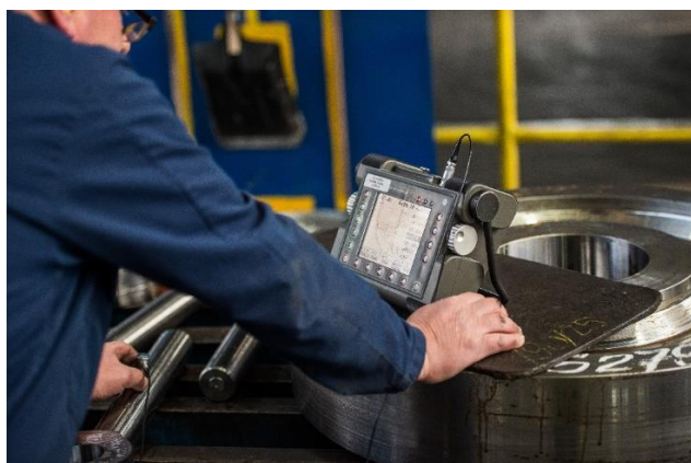
Pomiar przy użyciu defektoskopu
