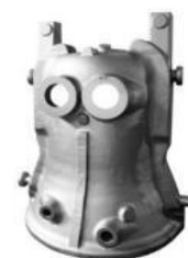
Korpus turbiny parowej waga 4 200 kg
